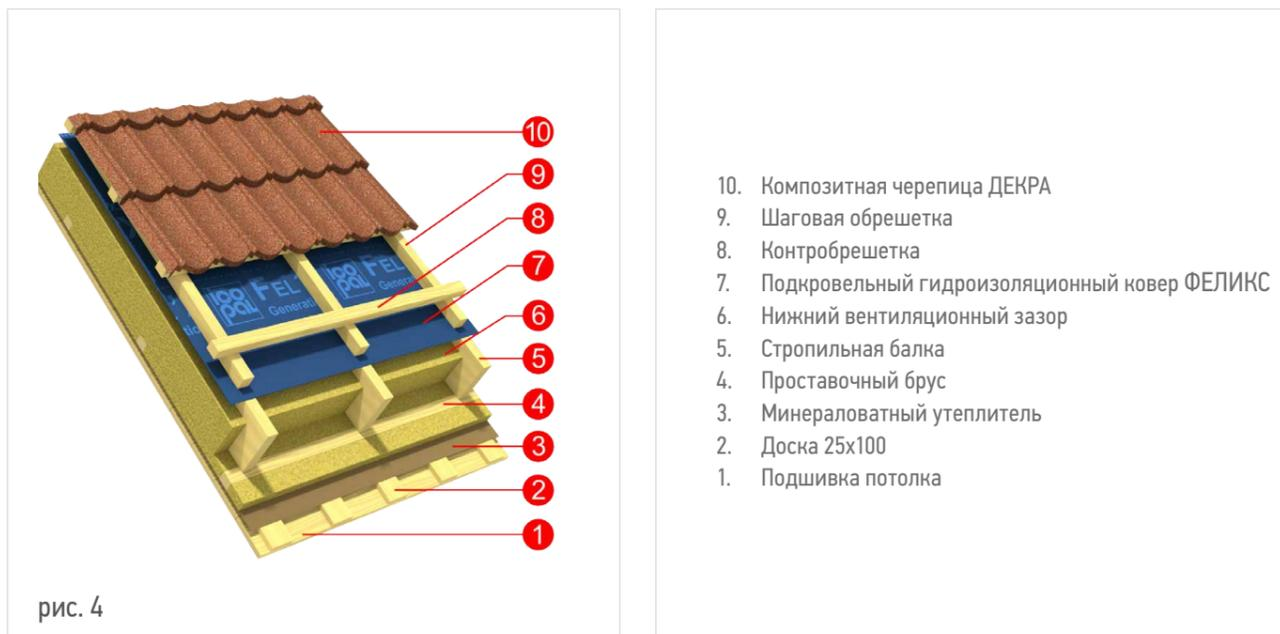
6.2.4. При необходимости, для устройства дополнительного слоя теплоизоляции, поперек стропильных балок снизу устанавливается проставочный брус. Размеры сечения проставочного бруса определяются проектом в зависимости от шага стропильных балок и толщины теплоизоляционного слоя.
