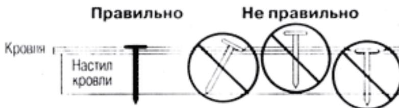
Если кровельный настил предполагается по толщине 19 мм и более, то гвозди должны уйти в настил на всю его толщину, то есть на 19 мм. Если толщина кровельного настила намного меньше, то гвозди должны углубиться в настил не меньше, чем на 3,2 мм.
