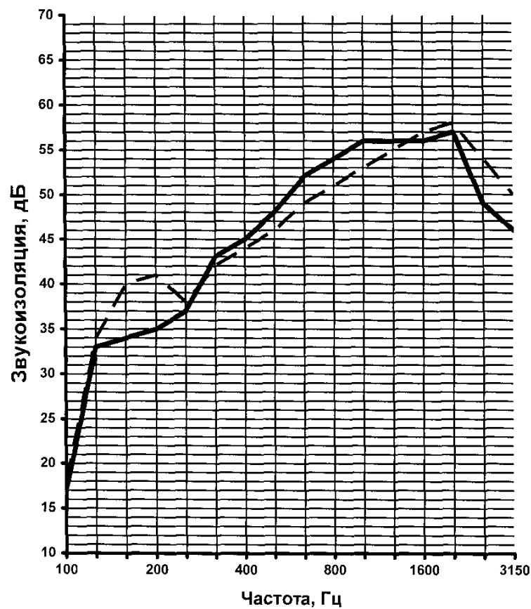
1. — - Металлический каркас ПС 100/50,  $m = 19,2 \text{ кг}/\text{м}^2$ ,  $R_w = 48,0 \text{ дБ}$
