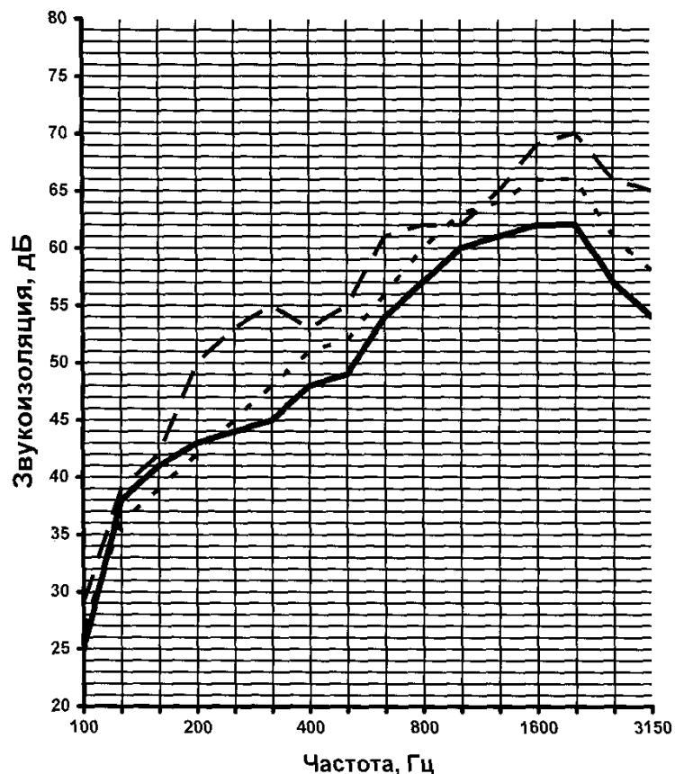
1. \_\_\_\_\_ - Каркас из металлического профиля ПС100/50,  $R_w = 53,9 \text{ дБ}$
