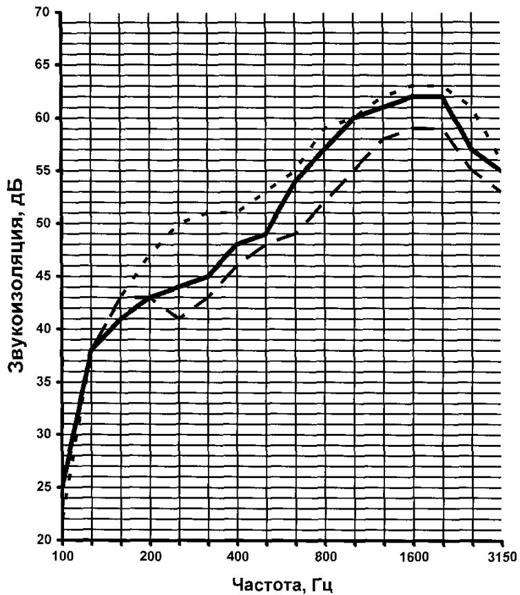
1. \_\_\_\_\_ - Каркас 100/50,  $m = 37,2 \text{ кг/м}^2$ ,  $R_w = 53,9 \text{ дБ}$
