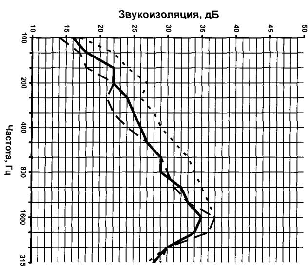
1. — — — ГКЛ производства ТМЛУ-Кнауф,  $m = 10 \text{ кг/м}^2$ ,  $R_w = 30,8 \text{ дБ}$
