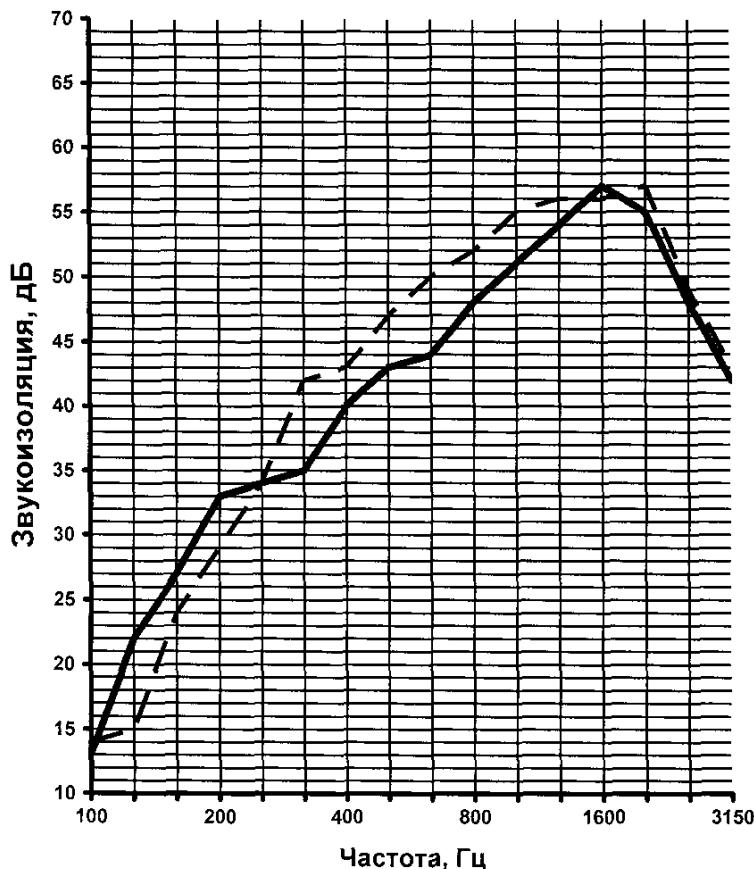
1. \_\_\_\_\_ - Каркас ПС 50/50, 2 ГКЛ Гипрок, стекловолокнистый мат Изовер КТ40,  $\gamma = 12 \text{ кг/м}^3$ ,  $d = 50 \text{ мм}$ ,  $m = 18,6 \text{ кг/м}^2$ ,  $R_w = 43,0 \text{ дБ}$
